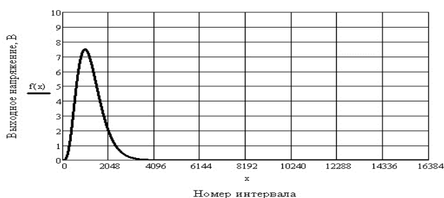
Рисунок 2 – График функции использованной для замены реального выходного сигнала канала измерения количества магнитной фазы
