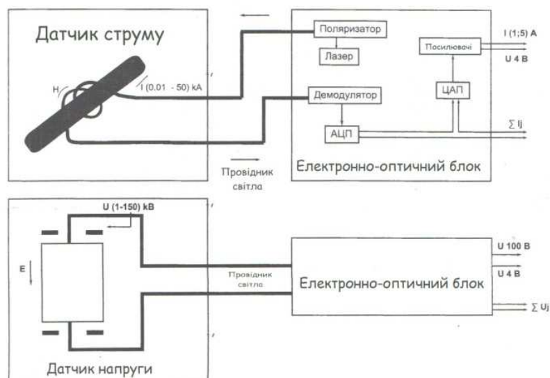
Рисунок 1 – Схема електронних вимірювальних трансформаторів струму та напруги
