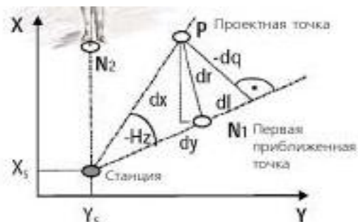
Рис. 3.1 – Геометрический смысл выноса проектной точки на местность
