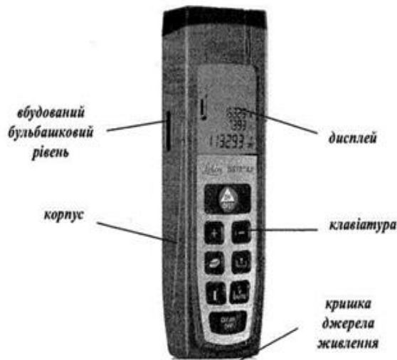
Будова лазерної рулетки Leica DISTO™ A3
