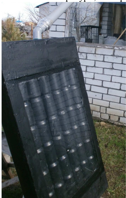
Мал. 1 – Сонячний колектор з алюмінієвих бляшанок
