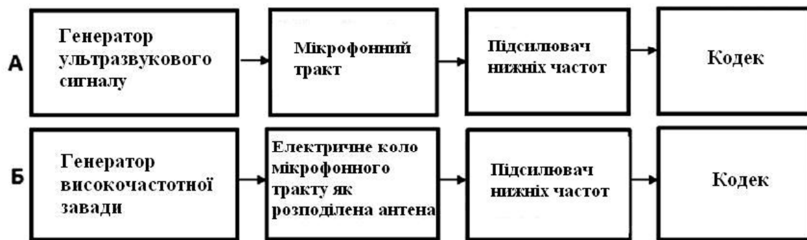
Рисунок. 1. Функціональна схема реалізації: а - ультразвукового способу пригнічення; б - електромагнітного способу пригнічення диктофонів
