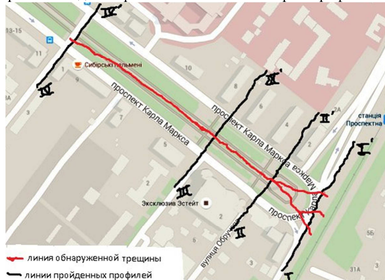
Рисунок 1 – Схема размещения профилей относительно монумента и распространения магистральных трещин
