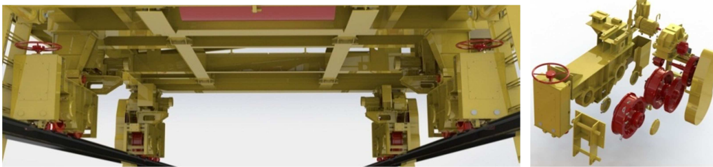
Рисунок 1. Компьютерная модель ходовой тележки
