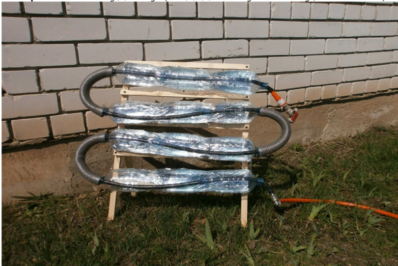
Мал. 2 Сонячний колектор із пластикових пляшок
