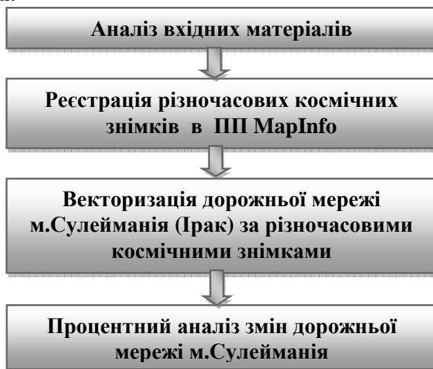
Рис. 1. Технологічна схема аналізу розвитку дорожньої мережі м.Сулейманія за різночасовими космічними знімками
